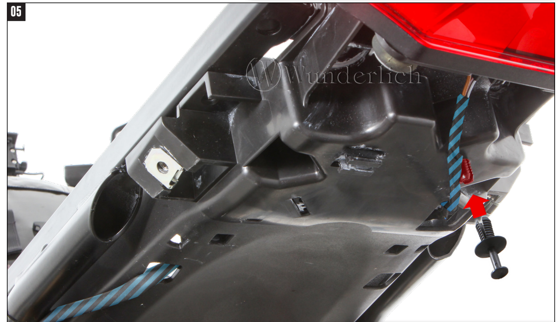
PVC-DÜBEL ENTFERNEN UND MIT DER FLACHEN SEITE VON UNTEN WIEDER EINSETZEN. Remove the PVC dowel and replace with the flat side from below.
