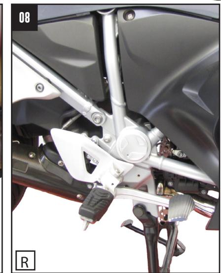
Nach der Montage ist die Hinterradbremse auf Freigängigkeit zu prüfen.
