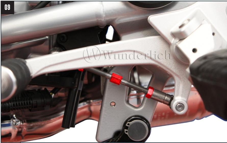
**Schalthebel einstellen: Kontermuttern lösen, Schalthebel anhand der Gewindestange einstellen und wieder kontern.**
