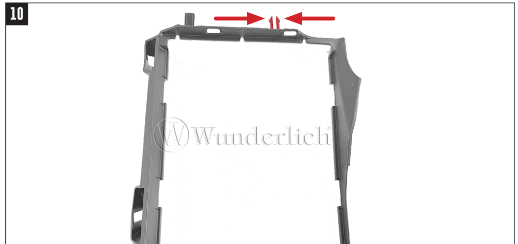
10 Halteklammern an markierter Stelle zusammendrücken und Kühlerverkleidung vorsichtig nach unten herausziehen. Dabei darauf achten, dass die Kühlrippen nicht beschädigt werden. Compress the retaining clips at the marked point and carefully pull the radiator cover downwards. Make sure that the cooling fins are not damaged. Comprimez les clips de retenue au niveau du point marqué et tirez délicatement le cache du radiateur vers le bas. Assurez-vous que les ailettes de refroidissement ne sont pas endommagées.
