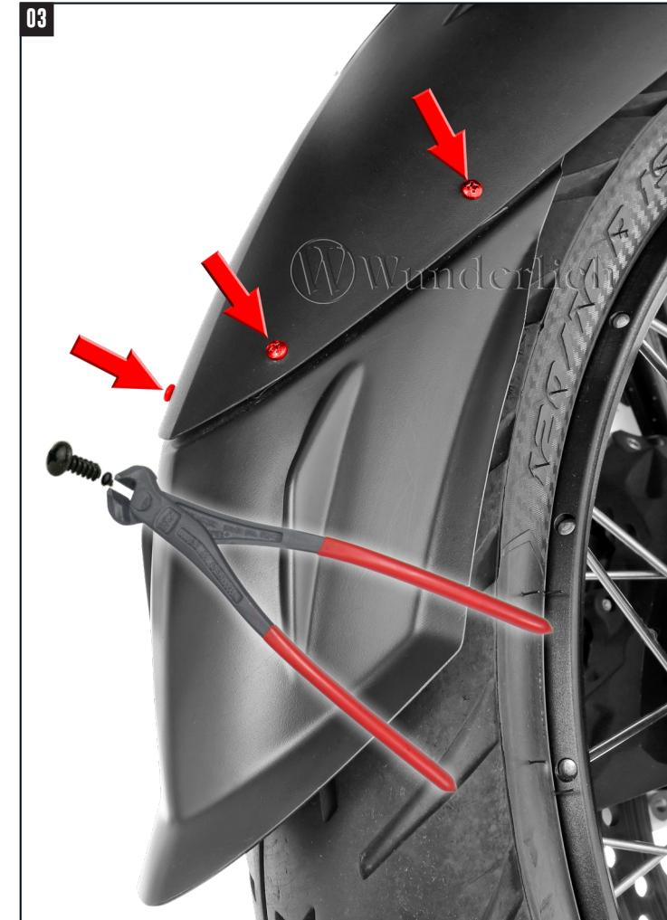
Falls die Schraubenspitze zu nah an den Reifen kommt, kann sie abgefeilt/geschnitten werden.
