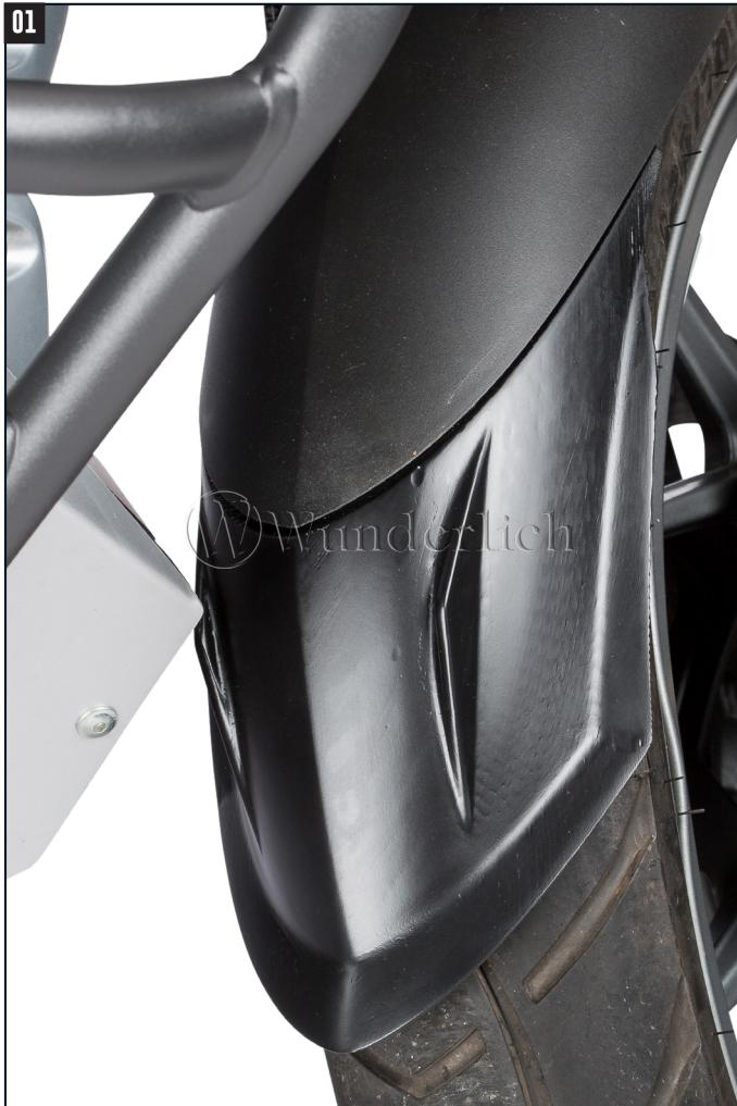
Probeweise sollten Sie zunächst den Extenda-Fender (ohne die Klebefolie zu entfernen) am Kotflügel anhalten. Kleben Sie den Extenda-Fender nun mittig unter den Kotflügel, so dass er möglichst paßgenau ansitzt.
