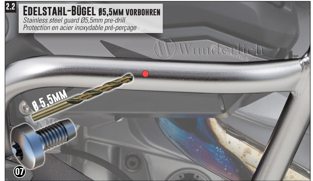
WIR EMPFEHLEN FÜR DEN ARBEITSSCHRITT „BOHREN“, DEN STURZBÜGEL ZU DEMONTIEREN. IM MONTIERTEM ZUSTAND BOHREN, SCHÜTZEN SIE DEN DAHINTER LIEGENDEN MOTOR BZW. DIE VENTILDECKEL. We recommend dismantling the crash bar for the drilling step. Drill in the assembled state, protect the motor or valve cover behind it. Nous vous recommandons de démonter la barre de protection pour l'étape de forage. Percez à l'état monté, protégez le moteur ou le couvercle de la vanne qui se trouve derrière.
