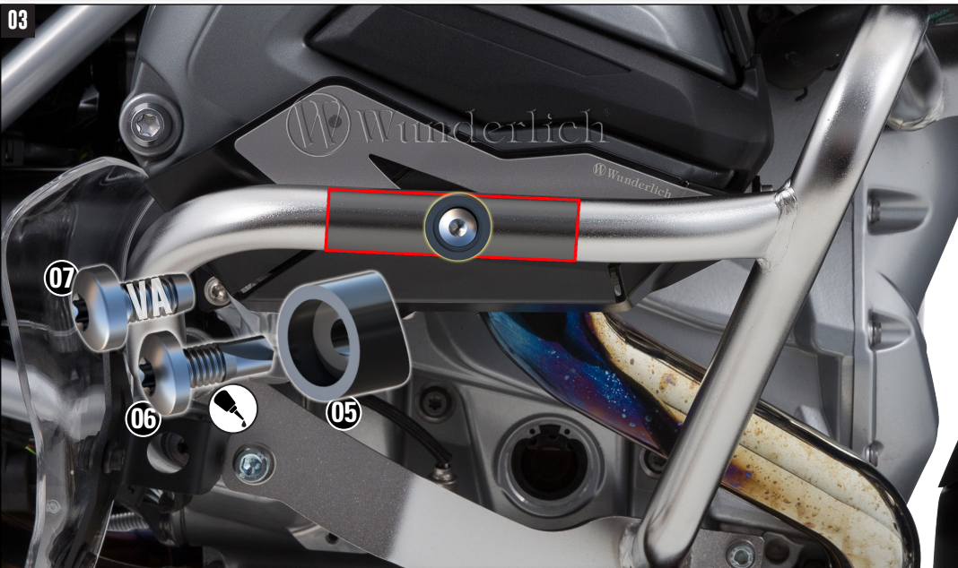
03 LACKSCHUTZFOLIE NUR IM ÄUßEREN BEREICH DES STURZBÜGELS VERWENDEN! Use paint protection film only in the outer area of the crash bar. Utilisez le film de protection de la peinture uniquement dans la zone extérieure du crash bar.
