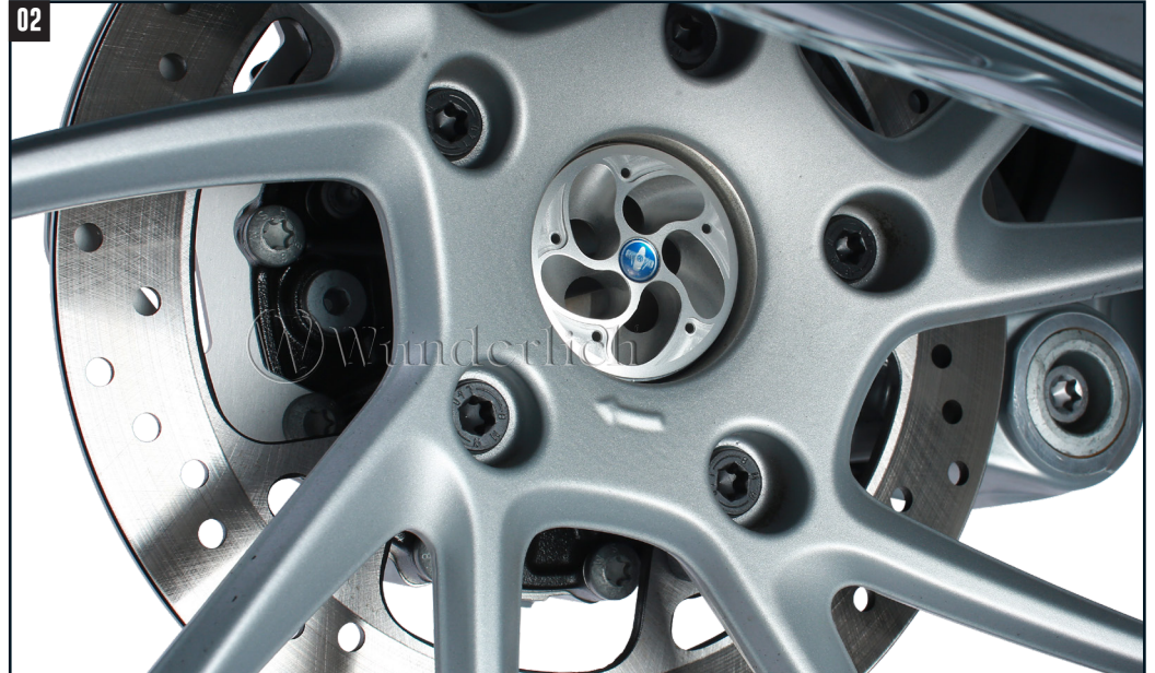
Nabenabdeckung bis zum Anschlag einschieben (Gummi Hammer)! Push in the hub cover until it stops (rubber mallet)!
