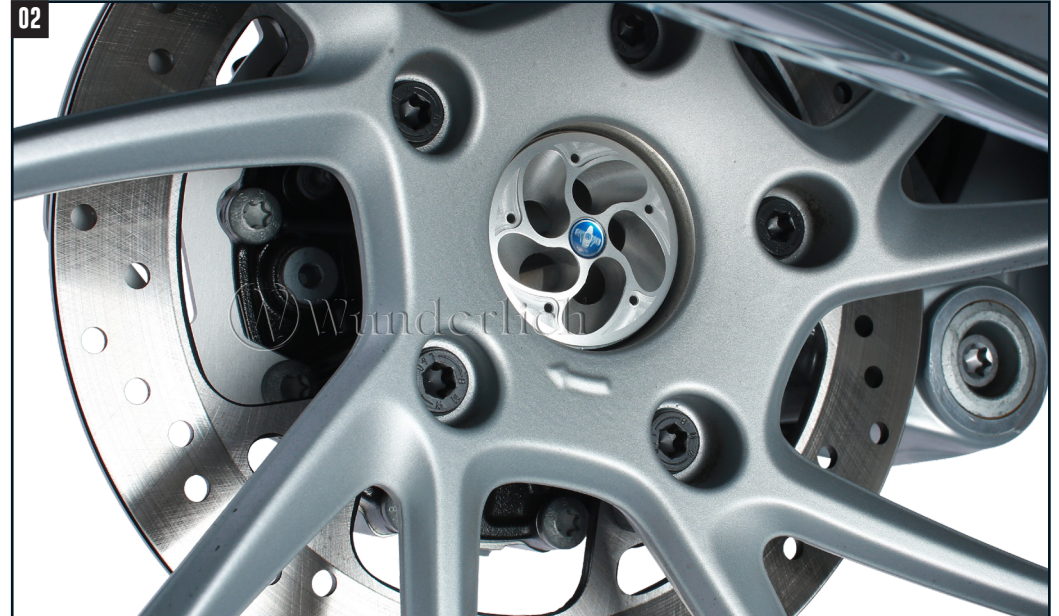
02 Nabenabdeckung bis zum Anschlag einschieben (Gummi Hammer)! Push in the hub cover until it stops (rubber mallet)!
