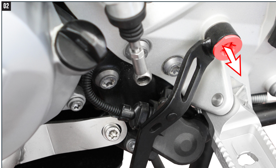
Innenliegende orig. Kонтerschraube wird zur Befestigung des Bolzens (Bild 3) benötigt! Inside orig. Locking screw is needed to fix the bolt (picture 3)!
